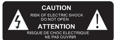
"Das Blitzsymbol mit Pfeil in einem gleichseitigen Dreieck soll den Benutzer auf elektrische Spannungen im Inneren des Produkts aufmerksam machen, die das Risiko eines elektrischen Schlags erzeugen können."
