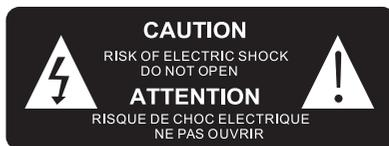
"Het symbool van de bliksem met het pijltje in een gelijkzijdige driehoek is een waarschuwingsteken om de aandacht van de gebruiker te vestigen op de aanwezigheid van elektrische netspanning in het product zelf, die een risico op elektrische schokken zou kunnen veroorzaken."
