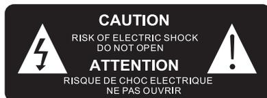
"El símbolo del relámpago con punta de flecha dentro de un triángulo equilátero constituye una advertencia destinada a avisar al usuario de la presencia de tensiones eléctricas dentro del producto, que pueden provocar un riesgo de electrocución."
